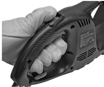
Figure 3-6: Faites glisser l'interrupteur vers l'avant
